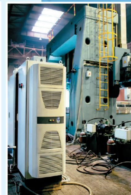
Смазка линейных направляющих станка импульсная от автономных станций с питателями параллельного действия.
