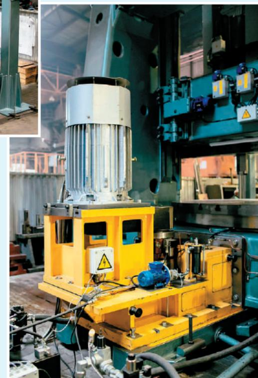
Левый токарный суппорт модернизирован под фрезерно-расточной суппорт, имеющий встроенный в ползун расточно-фрезерный шпиндель со своим приводом и с механизированным зажимом расточно-фрезерного инструмента. На торец ползуна установлена угловая фрезерная головка с приводом от расточно-фрезерного шпинделя. Для повышения точности применена гидроразгрузка веса ползуна.
